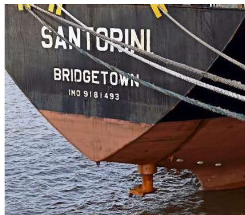
Die „Santorini“ liegt sicher vertäut an der Columbuskaje. Am Heck ist deutlich zu sehen: Das Ruderblatt ist weg. Foto: Scheer
